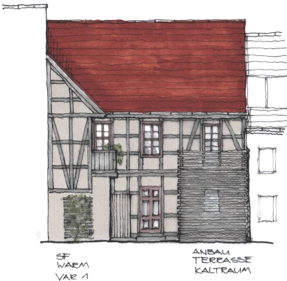
Abbildung 120: Impulsprojekt 2, Skizze Rückseite, saniertes Sichtfachwerk (Quelle: Holz)
