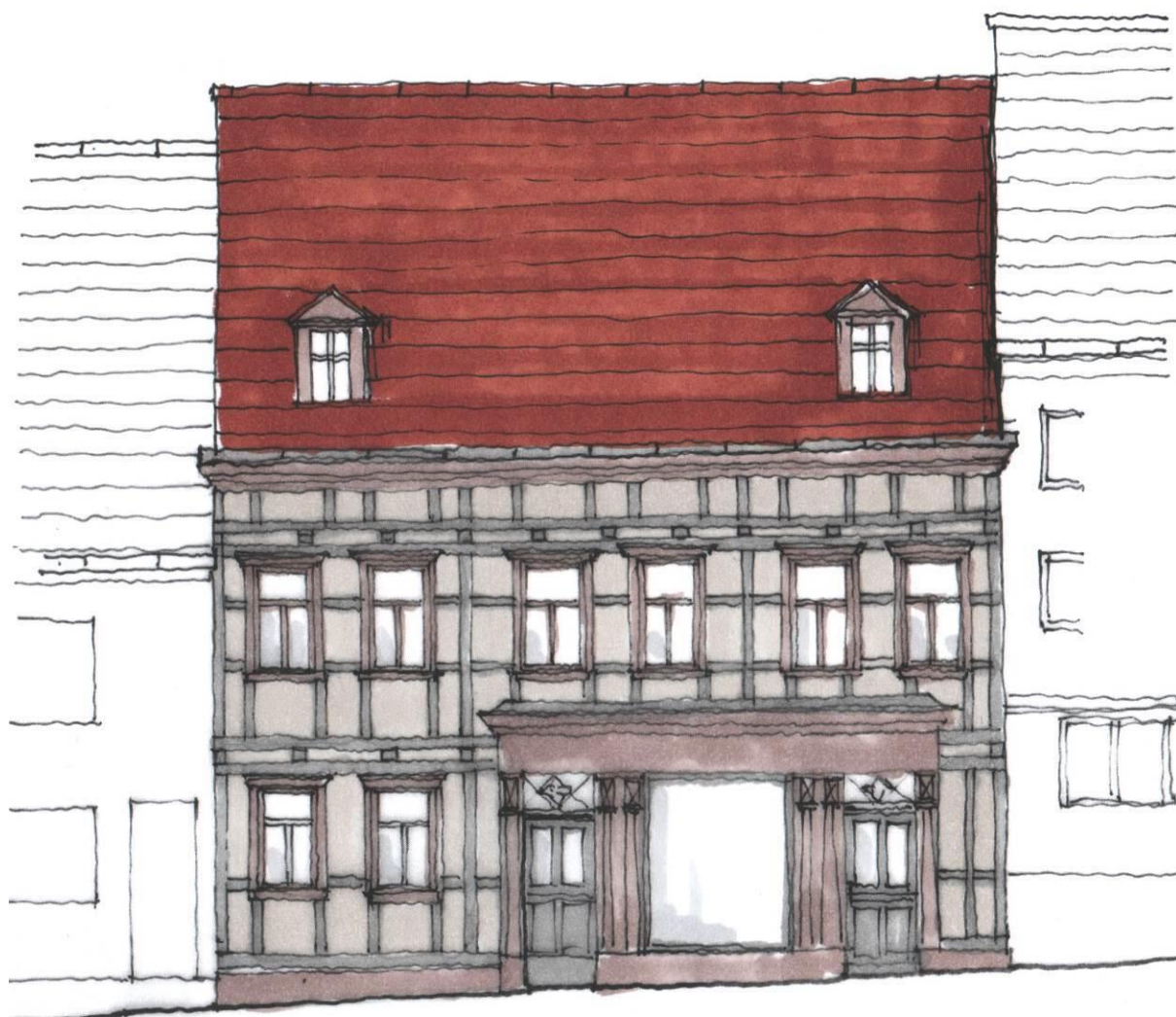
Abbildung 119: Impulsprojekt 2, Skizze Vorderseite, saniertes Sichtfachwerk (Quelle: Holz)
